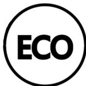
Ваш генератор оборудован ECO-режимом. Он позволяет снижать обороты двигателя при небольшой нагрузке (не более 50% от номинальной мощности генератора), а также в случаях, если подключенные приборы потребляют энергию неравномерно, с периодическими отключениями, например, холодильники, компрессоры, обогреватели и т. д.
