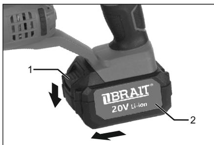
Чтобы извлечь аккумуляторную батарею, извлеките ее из инструмента, одновременно нажимая кнопку на передней панели аккумуляторной батареи. Чтобы установить аккумуляторную батарею, совместите выступ на аккумуляторной батарее с пазом в корпусе и вставьте ее на место. Вставляйте ее до упора, пока она не зафиксируется на месте с легким щелчком. Если вы видите красный индикатор на верхней стороне кнопки, она заблокирована не полностью.
