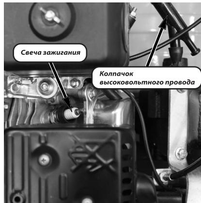
Снимите колпачок высоковольтного провода. Для извлечения свечи из двигателя пользуйтесь свечным ключом из комплекта. Проверяйте состояние свечи зажигания каждые 25 моточасов работы. Регулярно чистите свечу зажигания и проверяйте зазор между электродами. Зазор должен быть 0,6-0,7 мм. После проверки или замены закрутите свечу до упора свечным ключом.
