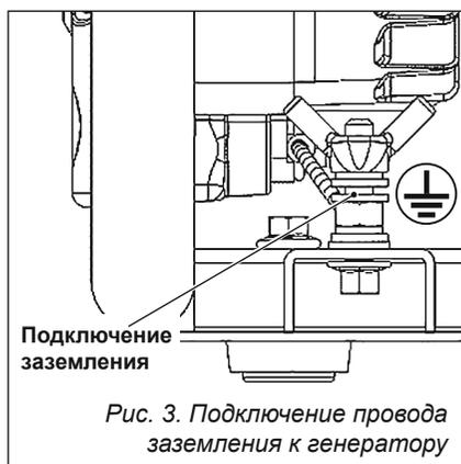
Рис. 3. Подключение провода заземления к генератору
