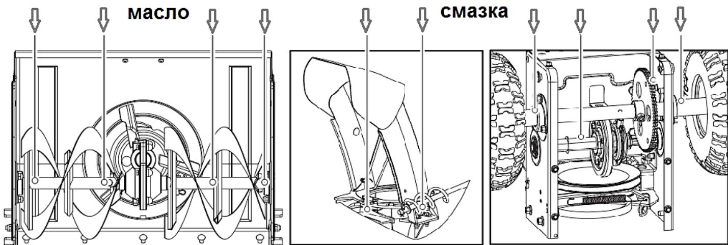
Будьте внимательны, смазка не должна попасть на фрикционное колесо или ремни. Для смазки оси шнека, снимите срезные штифты, для смазки осей колес снимите колеса.
