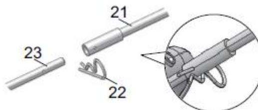
1. Совместите отверстия верхней части модуля контроля дефлектора (21) с отверстиями в нижней части (23).
