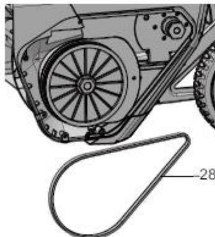
5. Используя торцевой ключ, снимите большой шкив (29).
