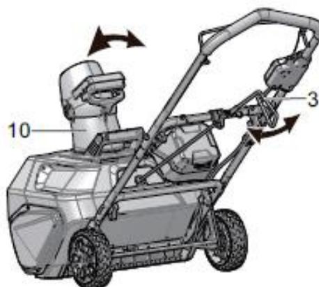
Разгрузочный желоб может поворачиваться на 180° для изменения направления выброса снега.
