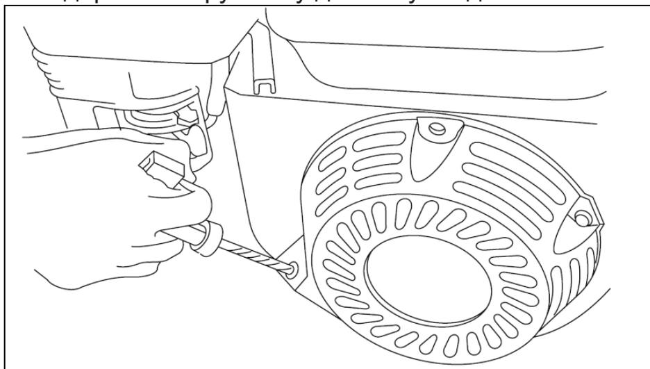
Рис. 11. Запуск двигателя ручкой стартера
