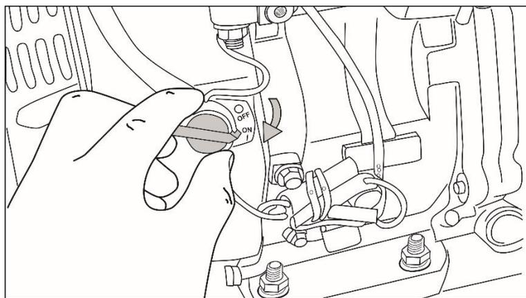
Рис. 9. Включение зажигания
