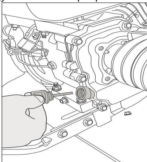
Рис. 2. Откручивание крышки наливной горловины двигателя
