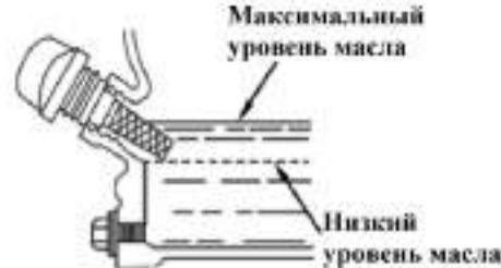
максимального уровня. После заливки масла не забудьте закрутить измеритель уровня масла. Если уровень масла ниже предельного уровня, система защиты масла остановит двигатель. Поэтому, чтобы избежать этой проблемы, пожалуйста, проверяйте уровень масла перед каждым запуском.
