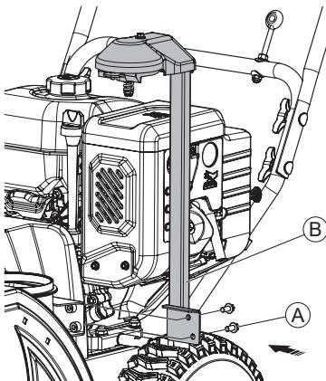
Установите поворотный механизм (B) на кронштейн снегоуборщика и закрепите при помощи болтов. Используйте крепёжные элементы из бокса №8: (A) болт M8x16 – 2 шт.
