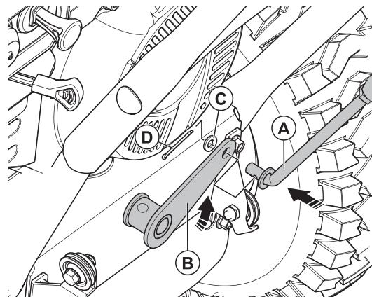
Установите на снегоуборочной машине в отверстие коннектора (B) тягу (A) и закрепите, используйте крепежные элементы - №15: (C) шайба - 1 шт.; (D) шплинт - 1 шт.
