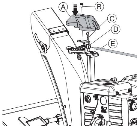
Проденьте рукоятку желоба через хомут нижней рукоятки и установите её в отверстие рулевого механизма, зафиксируйте штифтом. Установите декоративную крышку (A) и зафиксируйте ее. Используйте крепеж из бокса №13: (B) болт M6×12 – 1 шт.; (C) шплинт – 1 шт.
