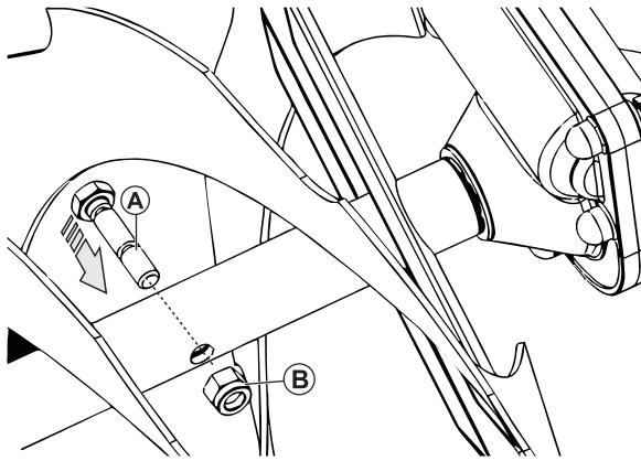
Шнеки крепятся к валу с помощью предохранительных (срезных) штифтов. В случае столкновения шнека с посторонним предметом или ледяным затором, штифты срезаются и шнек перестает вращаться, предотвращая повреждения других частей снегоуборщика.
