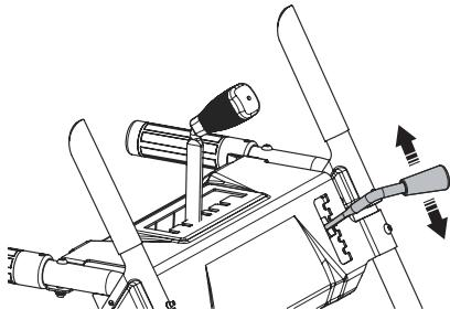
Для регулировки поворота желоба и дальности выброса снега используйте соответствующие рычаги. Внимательно следите за траекторией выброса снега.
