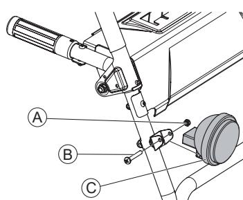
Установите фонарь освещения для этого установите его на скобу верхней рукоятки и прикрепите, используйте крепежные элементы – бокс №5: болт M6x40 – 1 шт.; штекер освещения и подогрева рукояток с проводом двигателя, закрепите провод на нижней рукоятке пластиковой клипсой из бокса №7. Обратите внимание, провод не должен касаться колеса.
