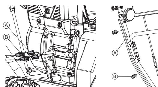
Соедините штекеры освещения и подогрева рукояток с проводом двигателя, закрепите провод на нижней рукоятке пластиковой клипсой из бокса №7. Обратите внимание, провод не должен касаться колеса.
