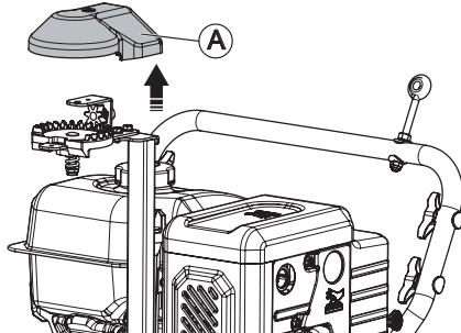
Снимите верхнюю крышку открутите установите и закрепите желоб, используя крепеж из бокса №10: (A) болт M6x12 – 1 шт.
