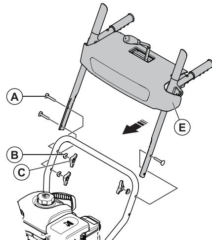
Совместите отверстия нижней и верхней рукояток, и закрепите при помощи болтов и пластиковых барашковых гаек. Используйте крепёжные элементы - бокс №3: (A) болт M8x50 – 3шт.; (B) фигуранная шайба – 3 шт.; (C) барашковая гайка M8 – 3 шт. Затяните болты от руки.
