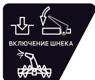
Нажмите на рычаг привода шнека по направлению к ручке управления, шнек начинает вращение и можно начинать расчистку снега. Для отключения шнека отпустите рычаг.
