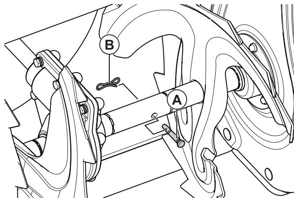
Шнеки крепятся к валу с помощью предохранительных (срезных) штифтов. В случае столкновения шнека с посторонним предметом или ледяным затором, штифты срезаются и шнек перестает вращаться, предотвращая повреждения других частей снегоуборщика.
