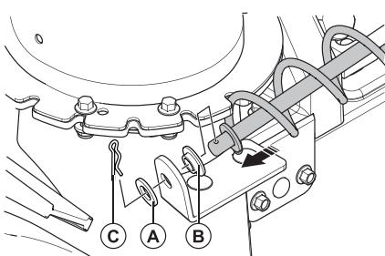
Для установки рукоятки поворотного желоба используйте крепежные элементы - бокс №5: (A) шайба - 1шт.; (B) пластиковая втулка - 1 шт.; (C) сплинт - 1шт.
