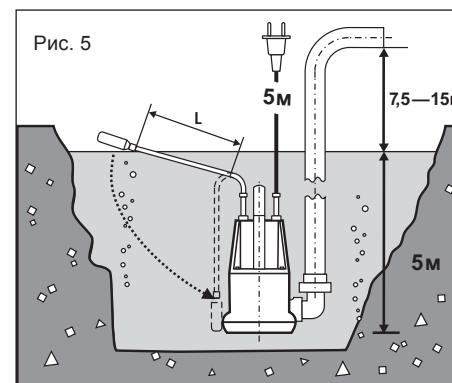
**ПРИМЕЧАНИЕ!** Уровни включения и выключения насоса регулируются **ОДНОВРЕМЕННО**. При установке определенного верхнего уровня (включения насоса) убедитесь, что в нижнем положении выключатель обеспечивает своеевременное (до оголения водозаборных отверстий в нижней части) выключение насоса.
