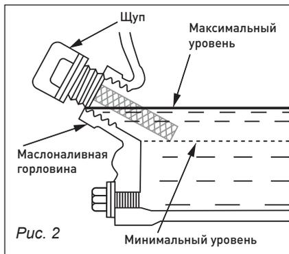
3. Залейте моторное масло (согласно заправочной емкости) до края заливной горловины.
