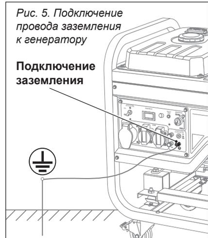
Рис. 5. Подключение провода заземления к генератору
