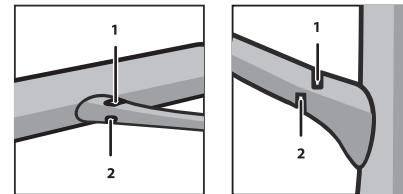
При опиливании веток, не находящихся под натяжением, сначала следует надпилить со стороны, в которую будет отпадать ветка, затем отпиливать с противоположной стороны. При отпиливании тонкой ветки пазы могут совпадать, при отпиливании толстой – обязательно иметь смещение.
