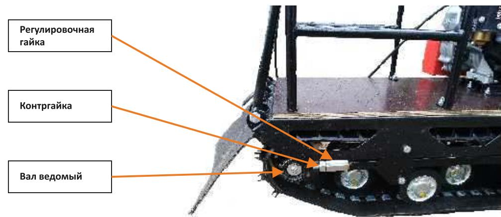
**Основные признаки перетянутой гусеницы:** мотобуксировщик «тяжело» трогается с места, «тяжело» разгоняется; частый перегрев двигателя в обычных условиях эксплуатации; мотобуксировщик, при сбрасывании газа перестает ехать накатом, т. е. сразу останавливается.
