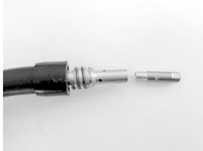
Рис. 13 Сопло находится в наконечнике Рис. 14 Сопло вывернуто из наконечника
