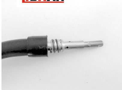
Рис. 13 Сопло находится в наконечнике Рис. 14 Сопло вывернуто из наконечника
