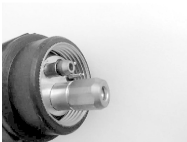
Рис. 15 Горелка с закрученным наконечником
