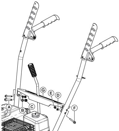
Установите панель переключения передач (G) закрепив ее крепежными элементами из бокса №3: (A) болт 6х40 – 2 шт.; (B) шайба D6 – 2 шт.; (C) гайка M6 – 2 шт.; (D) шайба D8 – 1 шт.; (E) гайка M8 – 1 шт.; (F) болт 8 – 1 шт.
