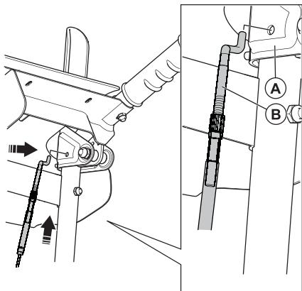
Для удобства установки рукояток, снимите колеса. Закрепите трос хода на рукоятке перед установкой.
