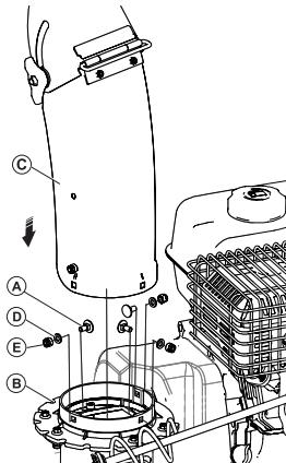
Установите поворотный желоб (С) на площадку снегоуборщика (В). Используйте крепёжные элементы - бокс №: 7 (А) болт 6x15 – 3 шт.; (Д) шайба D6 – 3 шт.; (Е) гайка M6 – 6 шт. и закрепите.
