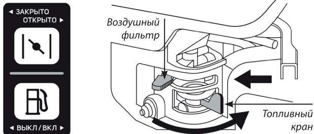
**Примечание!** Для повторного запуска горячего двигателя возможно оставить рычаг воздушной заслонки в положении «**OPEN**» (**ОТКРЫТО**).
