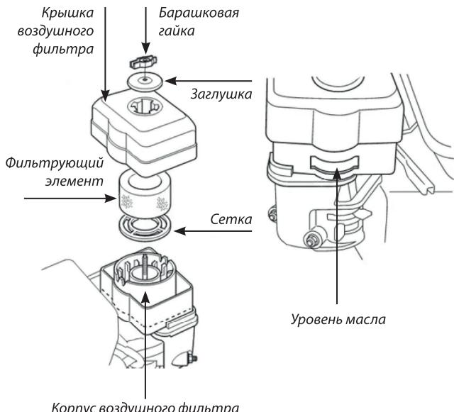
**9. ТЕХНИЧЕСКОЕ ОБСЛУЖИВАНИЕ****Порядок обслуживания фильтра с комбинированным фильтрующим элементом:**
