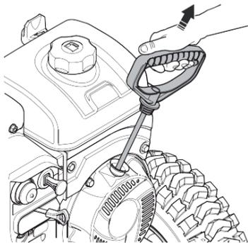
Не рекомендуется вытягивать шнур стартера максимально (на всю длину), а также резко не отпускайте его при повторной попытке завести двигатель, удерживая рукоятку, плавно верните его в исходное положение.
