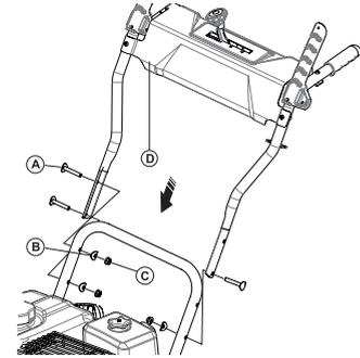
Совместите отверстия нижней и верхней рукоятки и закрепите их. Используйте крепежные элементы - бокс №2: (A) болт M8x50 – 3шт.; (B) фигурная шайба D8 – 3 шт.; (C) гайка с шайбой M8 – 3 шт. Затяните с моментом 25 N.m.
