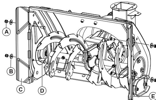
Установите пластины (C) и (E) на ковш и закрепите. Для установки используйте крепежные элементы – бокс №7: (D) болт M8x20 – 4 шт.; (B) шайба D8 – 4 шт.; (A) гайка M8-4 шт.
