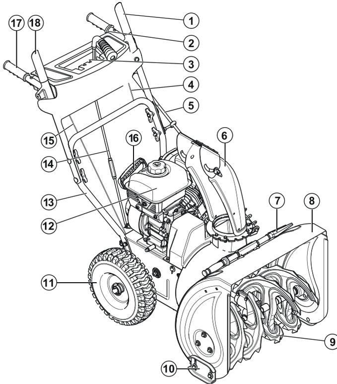
1. Рычаг включения привода шнека;
