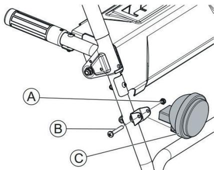
Смонтируйте и подключите фонарь освещения (C) на скобу верхней рукоятки, используйте крепежные элементы – бокс №8: (B) болт M6x40 – 1 шт.; (A) гайка M6 – 1 шт.
