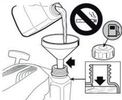
Если топливо пролилось, уберите снегоуборочную машину от места разлива топлива. Избегайте источников образования искры, пока пары бензина полностью не выветрятся. Протрите насухо пролитое масло или топливо. Не храните топливо и не заполняйте бензобак вблизи открытого пламени.
