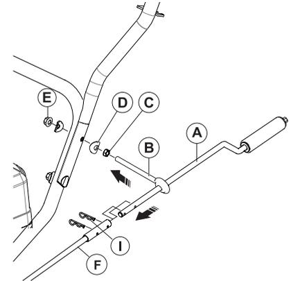
Соедините между собой части рукоятки поворотного желоба (А) и (F), и присоедините к левой ручке, при помощи крепёжных элементов - бокс № 5: (С) гайка М8 – 1 шт.; (D) фигурная шайба D8 – 2 шт.; (E) гайка с шайбой М8 – 1 шт.; (I) шплинт – 2 шт
