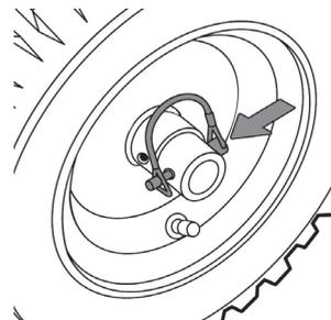
Присоедините тягу переключения передач регулируемым штоком (F) в проушину (G) панели управления, стороной (A) в коннектор (C) снегоуборочной машины, закрепив ее крепежными элементами из бокса №3: (B) пружина – 2 шт.; (D) шайба – 1 шт.; (E) шплинт – 2 шт.; (H) шайба – 1 шт
