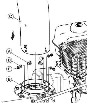
Установите поворотный желоб (С) на площадку снегоуборщика (В). Используйте крепёжные элементы - бокс №: 6 (А) болт М6х15 – 3шт.; (D) шайба D6 – 3 шт.; (E) гайка М6 - 3 шт. и закрепите.
