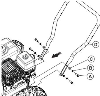
Совместите крепежные отверстия на нижней рукоятке (D) и на корпусе снегоуборщика. Используйте крепежные элементы - бокс №1: (A) болт M8x50 – 4шт.; (B) гроверная шайба D8 – 4 шт.; (C) шайба D8 – 4 шт. Затяните с моментом 25 N.m.
