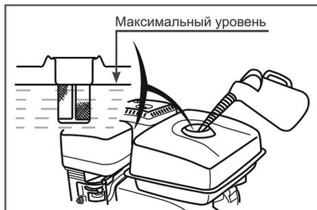
Рис. 9 Максимальный уровень топлива в топливном баке
