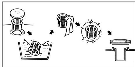
**Рис. 22 Обслуживание сетчатого фильтра в горловине топливного бака**
