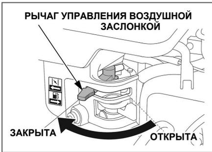
Рис. 10 Рычаг управления воздушной заслонкой
