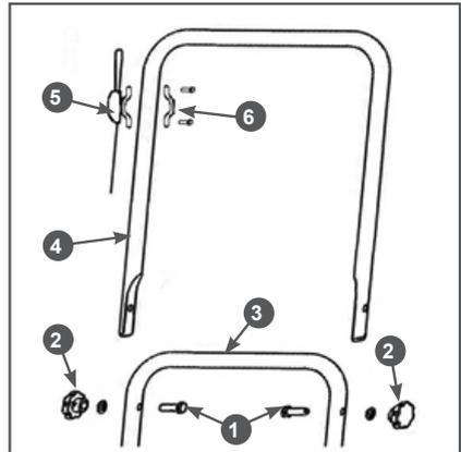
Рис. 5В Установка рабочей рукоятки
