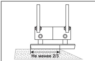
**Рис. 14** Расположение виброплиты на краю обрабатываемой поверхности
