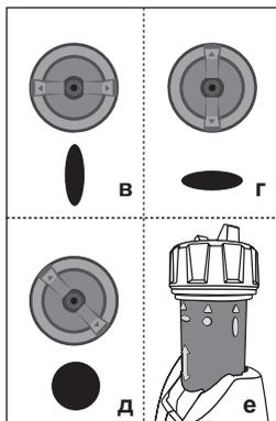
При пробной окраске определите необходимую скорость ведения распылителя для равномерной окраски и расход материала, во избежание, при большой скорости и недостаточном расходе, неравномерного покрытия; а при низкой скорости и избыточном расходе – потеков материала. Регулировка расхода материала осуществляется вращением регулятора 1.
