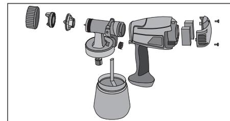
10) снимите заднюю крышку и выньте воздушные фильтры. Очистите их сжатым воздухом или промойте в воде. Дайте высохнуть перед установкой обратно.
