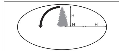
Перед началом валки дерева определите естественный наклон дерева и направление ветра, а также оцените расположение наиболее тяжелых веток и с учетом этих факторов определите направление падения дерева. Примите меры, чтобы в зоне его падения, не находились люди, животные, линии электропередач, телеграфные провода, строения, техника и иные объекты.
