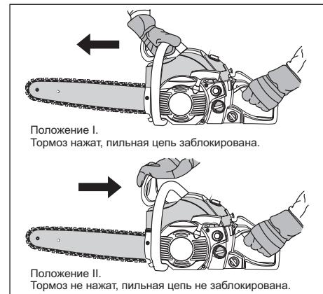
**ПРИМЕЧАНИЕ!** Не допускайте работу двигателя с заблокированной цепью в течение более чем 2 сек, т.к. это может привести к перегреву муфты, ее заклиниванию и выходу из строя. Выключите двигатель или разблокируйте цепь рычагом **4**.
