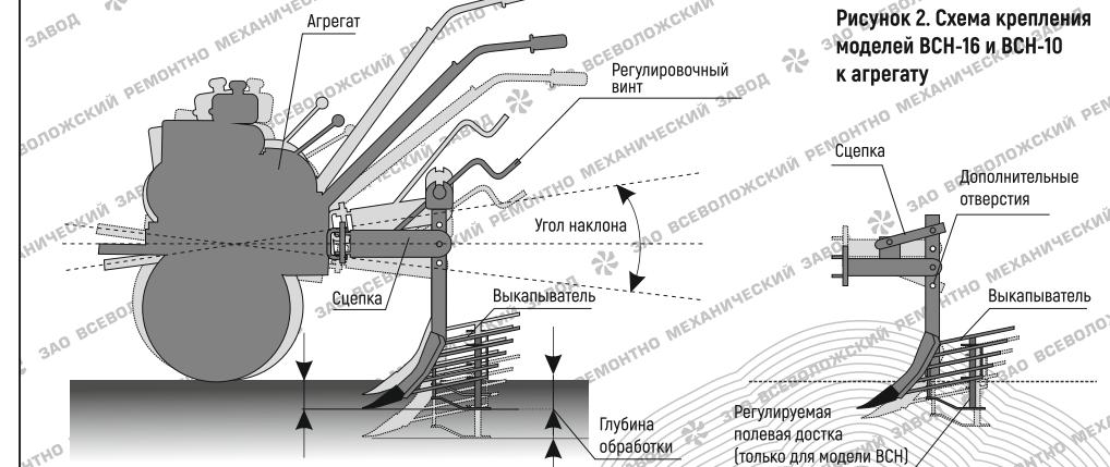
Рисунок 2. Схема крепления моделей BCH-16 и BCH-10 к агрегату
