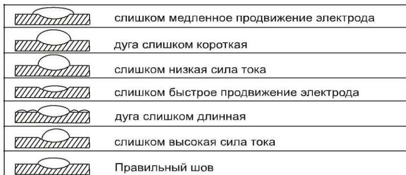
Таблица 4. Виды сварочного шва при различных параметрах
