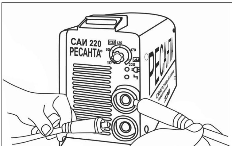
Рис. 4. Подключение кабелей
