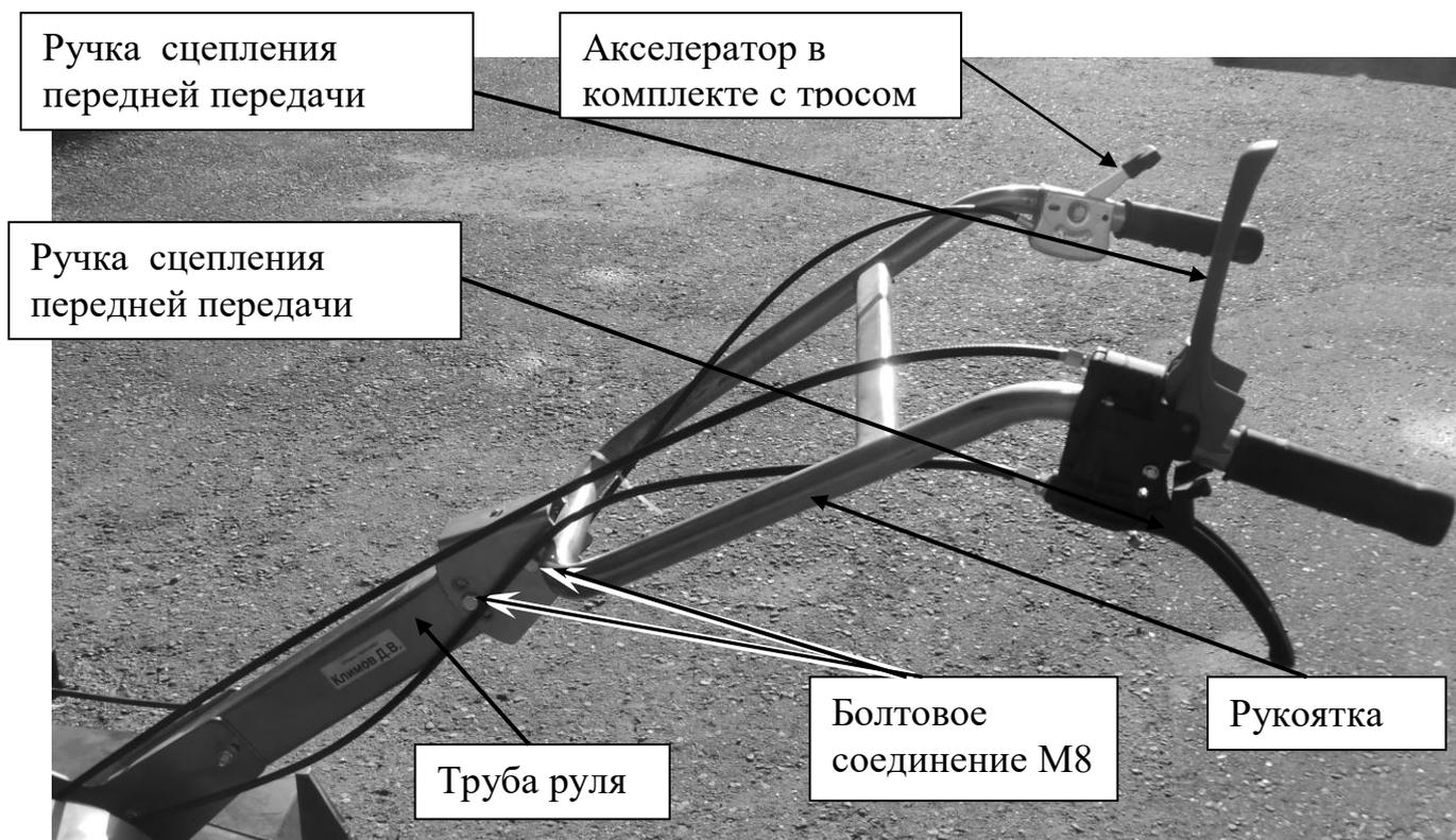
Рис.7 Руль в сборе – схема сборки и регулировки.
