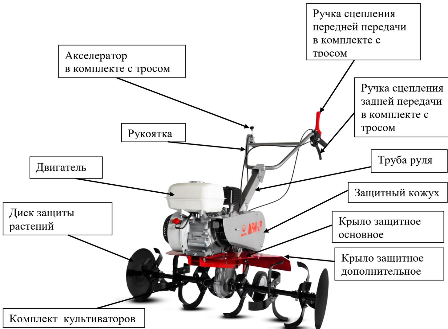
Рис.1 Мотокультиватор МКМ-1Р
