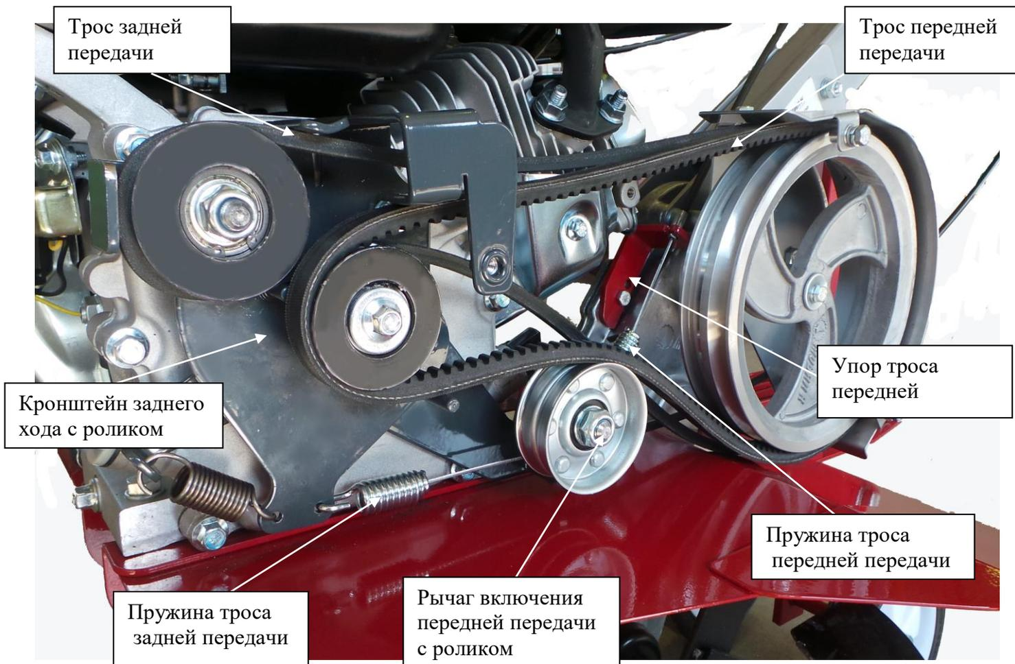
Рис.4 Установка тросов включения передней и задней передач
