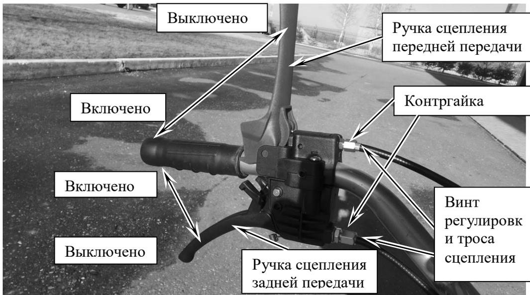
Рис.8 Ручки сцепления в комплекте с тросом.
