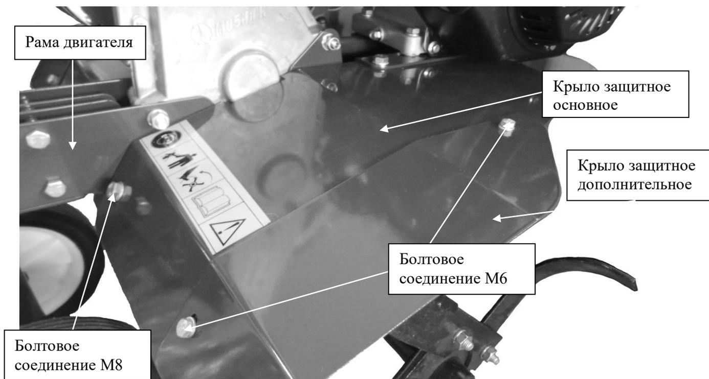
Рис. 13 Установка крыльев
