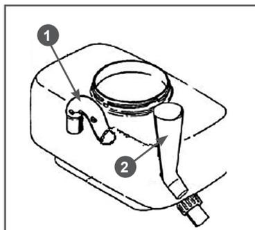
**Рис. 13 Установка воздушной трубки и воронки в баке**
