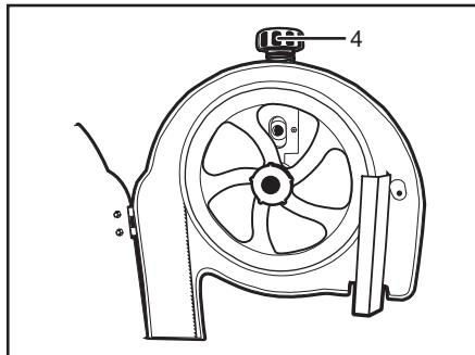
■ ослабьте натяжение полотна, вращением винта 4 против часовой стрелки опустив верх-
