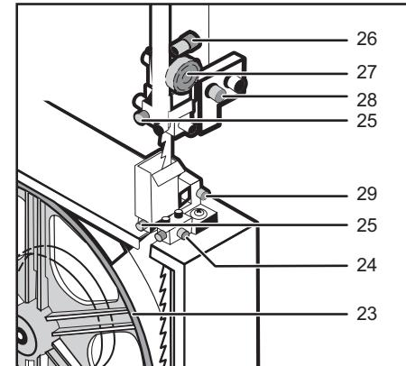
■ обеспечьте подпор подшипником 27 полотна против смещения его под нажимом обрабатываемой заготовки. Для этого вращением регулировочного винта 26 установите зазор между подшипником и задним ребром полотна равный 0,7–1 мм. Затяните стопорный винт;
