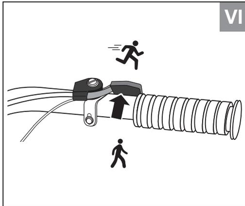
9. Движение вперед и регулировка оборотов двигателя
