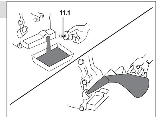
12. Обслуживание воздушного фильтра двигателя
