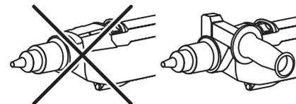
Работа без установленной дополнительной рукоятки ЗАПРЕЩАЕТСЯ
