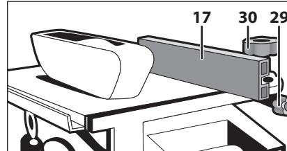
► установите на транспортире упор продольный, вставив шляпки винтов фиксатора в паз упора. Затяните гайки-барашки;
