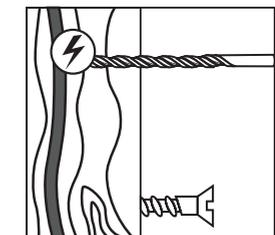
При сверлении отверстий / заворачивании крепежа в стены предварительно убедитесь в отсутствии в данном месте скрытой проводки.
