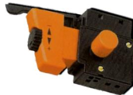
точно по центру клавиши расположен контроллер скорости (черная кнопка), который используется для ограничения максимальной скорости инструмента, во избежание чрезмерного усилия, которое может привести к поломке устройства. При вращении по часовой стрелке скорость увеличивается, при вращении против часовой стрелки скорость уменьшается.
