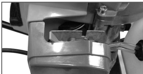
Рис. 8 Рычаг воздушной заслонки
