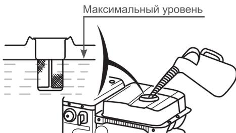
Рис. 2 Максимальный уровень топлива в топливном баке
