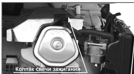
Рис. 14 Место расположения свечи зажигания
