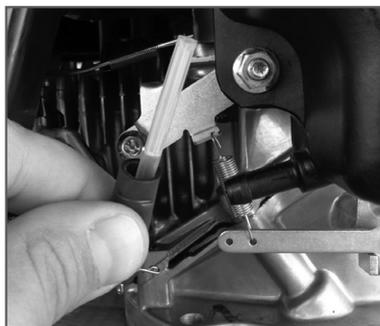
Рис. 16 Топливный фильтр
