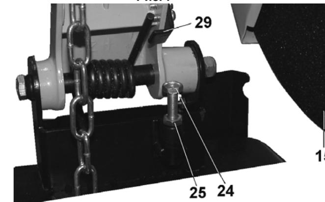
11.6. Перемещение отрезного диска (15) к заготовке и скорость подачи резания производится ручным усилием оператора на ручку (10). Избыточное давление (повышенная скорость подачи) на ручку (10) может привести к разрушению отрезного диска (15) и повлечь за собой травму.
