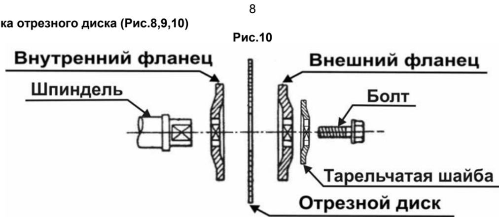
Перед установкой отрезного диска (15) на машину внимательно осмотрите его. На нём не должно быть сколов и трещин, поверхности отрезного диска должны быть ровными, сухими и чистыми.
