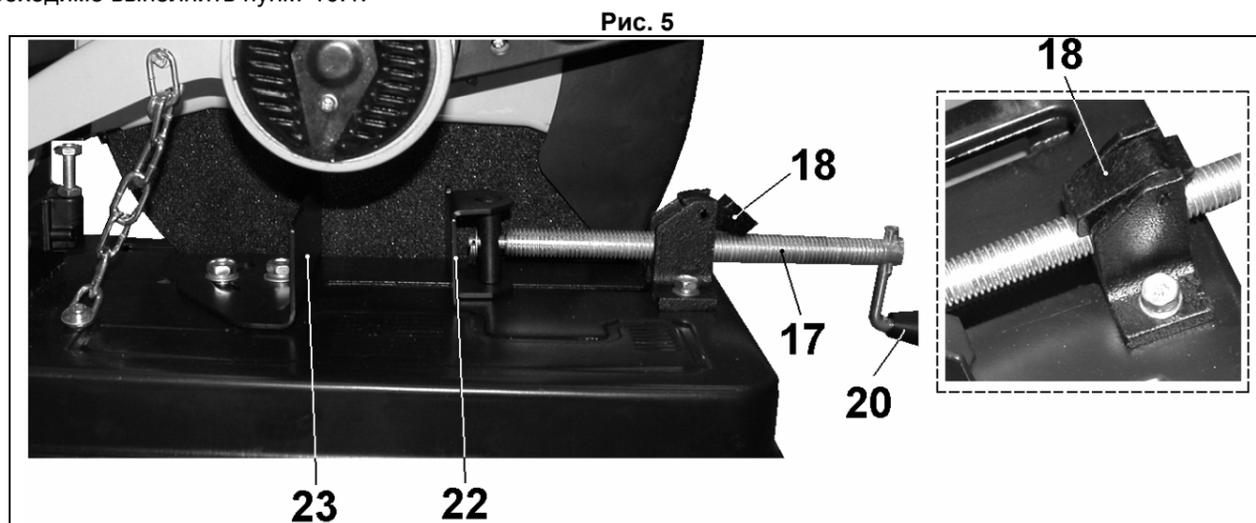
11.2. Как показано на Рис.6, откиньте полугайку (18), переместите ходовой винт (17) в положение, достаточное для установки заготовки. Установите заготовку и, как показано на Рис.5, опустите полугайку (18). Вращая до определённого усилия ходовой винт (17) за ручку (20), надёжно закрепите заготовку. При использовании длинных заготовок обеспечьте надёжную фиксированную опору по всей длине заготовки.
