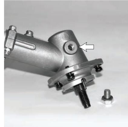
Раз в три месяца проверяйте наличие смазки в редукторе. При необходимости надо сменить смазку или обратиться в авторизованный сервисный центр. Для смазки редуктора можно использовать оригинальную графитовую смазку Arsenal компании Patriot. Перед обслуживанием редуктора промойте его Универсальным очистителем Arsenal.
