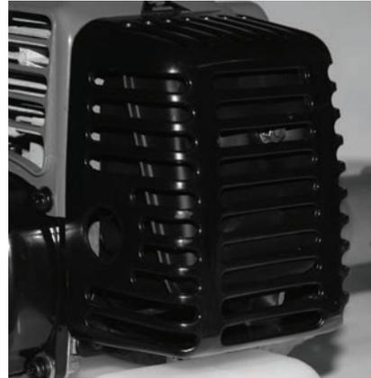
В зависимости от использования триммера необходимо чистить искрогаситель двигателя. Использование загрязненного искрогасителя может отрицательно сказаться на мощности двигателя и качестве покоса.
