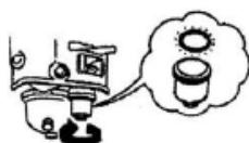
4. Вывинтите пробку сливного отверстия, освободите карбюратор от топлива.
