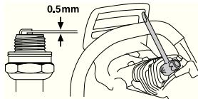
Обратите внимание! Всегда используйте только указанный тип свечи! Применение несоответствующей модели может привести к серьезным повреждениям поршня/цилиндра. Следите за тем, чтобы свеча была оснащена т.н. изоляцией радиопомех.
