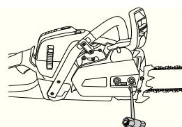
Цепь считается натянутой правильно, если она свободно проворачивается рукой. После этого , удерживая носок пильного полотна в вверхнем положении, затяните гайки крепления пильного полотна универсальным ключом.
