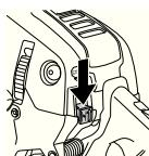
Остановка двигателя осуществляется нажатием на выключатель запуска/остановки. ПОМНИТЕ! Выключатель Запуск/Остановка автоматически переходит рабочее положение. В целях избежания непроизвольного запуска, головка свечи должна быть всегда снята со свечи когда вы оставляете машину без присмотра.
