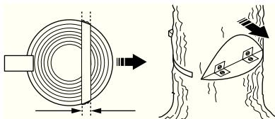
Возможность влияния на направление падения будет полностью утрачена, если полоса разлома слишком узкая или пропилы направляющий и основной пропилы плохо расположены.
