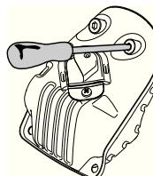
В некоторых глушителях предусмотрен специальный искрогаситель. Если ваша машина оборудована таким глушителем, сетку фильтра следует чистить раз в неделю. Наилучшие результаты получаются при использовании стальной щеткой. Забитая решетка приводит к работе с горячим двигателем, что дает серьезные повреждения двигателя.
