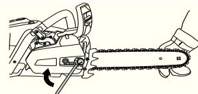
При установки новой цепи следует часто проверять ее натяжение , пока цепь не приработается. Регулярно проверяйте натяжение цепи. Регулярно проверяйте натяжение цепи. Правильно натянутая цепь обеспечивает высокое качество пиления и дольше служит.
