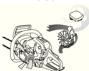
**ВАЖНО!** Для осуществления метода центробежной очистки нужно постоянно выполнять техническое обслуживание и уход за системой. Необходимо чистить воздухозаборник стартера, лопасти вентилятора на маховике, пространство вокруг маховика, входного коллектора и карбюратора.
