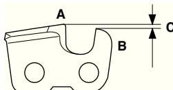
**ПРЕДУПРЕЖДЕНИЕ!** Чрезмерно большое ограничение глубины врезания увеличивает риск отдачи пильной цепи!
