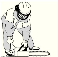
Твердо возмите моторную пилу, обхватив ручки всей ладонью.
