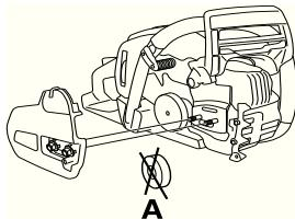
Установите пильное полотно на специально предназначенные болты. Установите полотно в самое заднее положение. Оденьте цепь на ведущую звездочку и вставьте ее хвостовики в паз пильного полотна. Начнайте с верхней стороны пильного полотна.
