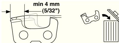
Общие сведения относительно снижения ограничителя глубины врезания.
