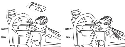
Для более тщательной чистки фильтр следует помыть в воде с мылом.
