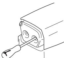
В некоторых глушителях предусмотрен специальный искрогаситель. Если ваша машина оборудована таким глушителем, сетку фильтра следует чистить раз в неделю. Наилучшие пользуйтесь стальной щеткой. Забитая решетка приводит к работе с горячим двигателем, что дает серьезные повреждения двигателя.
