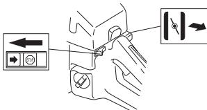
Если машина оборудована декомпрессионным клапаном (A): Его необходимо нажать, чтобы уменьшить давление в цилиндре и облегчить запуск машины. При запуске машины всегда пользуйтесь декомпрессионным клапаном.
