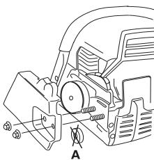
Установите пильное полотно на специально предназначенные болты. Установите полотно в самое заднее положение. Оденьте цепь на ведущую звездочку и вставьте ее хвостовики в паз пильного полотна. Начинайте с верхней стороны пильного полотна.
