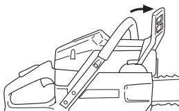
**Зажигание:** Установите переключатель зажигания в левое положение.
