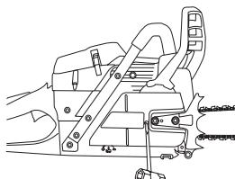
Цепь считается натянутой правильно, если она свободно проворачивается рукой. После этого , удерживая носок пильного полотна в верхнем положений, затяните гайки крепления пильного полотна универсальным ключом.
