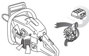
**ВАЖНО!** Для осуществления метода центробежной очистки нужно постоянно выполнять техническое обслуживание и уход за системой. Необходимо чистить воздухозаборник стартера, лопасти вентилятора на маховике, пространство вокруг маховика, входного коллектора и карбюратора.
