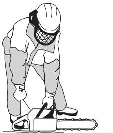
Твердо возьмите моторную пилу, обхватив ручки всей ладонью.
