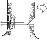
Вставьте зубчатый упор (если установлен) сзади надреза. Работайте на полном газу и вводите пильное полотно в ствол дерева постепенно, плавным движением. Следите за тем, чтобы дерево не начало перемещаться в направлении, противоположном предполагаемому направлению падения. Как только пропил станет достаточно глубоким, загоните в него клин или вагу.
