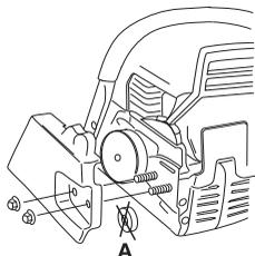
Установите пильное полотно на специально предназначенные болты. Установите полотно в самое заднее положение. Наденьте цепь на ведущую звездочку и вставьте ее хвостовики в паз пильного полотна. Начинать с верхней стороны пильного полотна.
