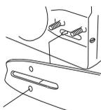
Для этого поверните винт механизма регулировки цепи по часовой стрелке. Цепь следует натягивать до тех пор, пока она не будет плотно прилегать к нижней стороне пильного полотна. См. указания в разделе Натяжение цепи пилы.
