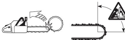
Отдача всегда происходит в плоскости резания пилы. Обычно при отдаче моторную пилу отбрасывает назад и вверх в направлении рабочего. Тем не менее моторная пила в момент отдачи может двигаться в различных направлениях в зависимости от метода резки, который применялся в момент касания зоны отдачи полотна и объекта.
