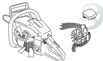
**ВАЖНО!** Для осуществления метода центробежной очистки нужно постоянно выполнять техническое обслуживание и уход за системой. Необходимо чистить воздухозаборник стартера, лопасти вентилятора на маховике, пространство вокруг маховика, входного коллектора и карбюратора.
