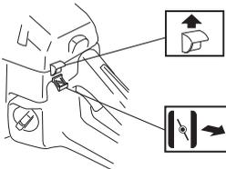
Топливный насос: Если машина укомплектована топливным насосом (А): Сожмите несколько раз резиновую грушу топливного насоса пока в нее не начнет поступать топливо. Грушу нет необходимости заполнять полностью.
