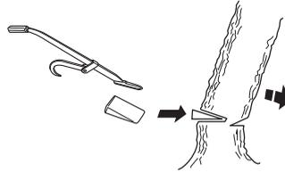
Мы рекомендуем пользоваться шиной пилы, длина которой бы превышала диаметр ствола, чтобы валяющий и направляющий срезы могли выполняться т.н. "одинарным срезом". См. указания в разделе Технические данные, относительно рекомендуемой длины шины пилы для Вашей модели моторной пилы.
