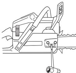
Цепь считается натянутой правильно, если она свободно проворачивается рукой. После этого, удерживая носок пильного полотна в верхнем положении, затяните гайки крепления пильного полотна универсальным ключом.
