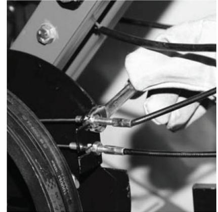
Со временем тросы привода могут растянуться. Для их регулировки необходимо расконтрить гайки и добиться оптимального натяжения тросов. Идеальным натяжением считается, когда надежное вращение ремней обеспечивает заданный режим работы. Одновременно ремни вращаться не должны.
