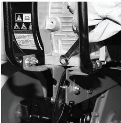
Открутите болт сливного отверстия и крышку маслосливной горловины. Слейте отработанное масло. Производите замену моторного масла первый раз после 5 моточасов работы. Периодичность замены моторного масла во время эксплуатации мотокультиватора один раз каждые 50 моточасов работы.
