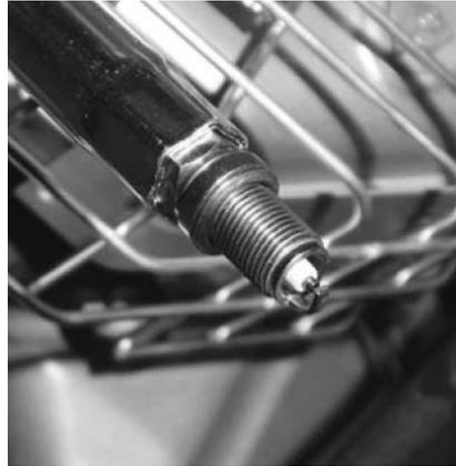
Проверяйте состояние свечи зажигания каждые 25 моточасов работы. Регулярно чистите свечу зажигания и проверяйте зазор между электродами. Зазор должен быть 0,6-0,7 мм. После проверки или замены закрутите свечу до упора свечным ключом.
