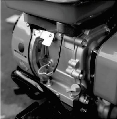
Двигатель необходимо очищать от грязи каждый раз после окончания работы с мотокультиватором. Грязный двигатель и загрязненные ребра цилиндра могут стать причиной его перегрева и поломки.
