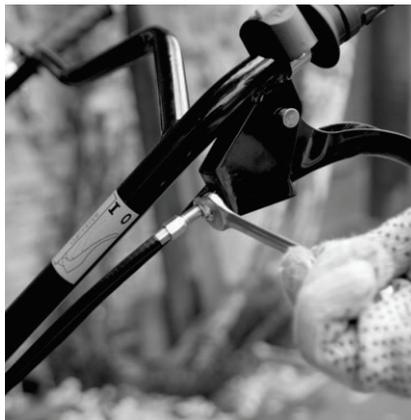
Со временем тросы привода могут растянуться. Для их регулировки необходимо расконстрировать гайку и добиться оптимального натяжения тросов. Оптимальной регулировкой троса является начало движения культиватора при нажатом рычаге сцепления на  $\frac{1}{3}$ .
