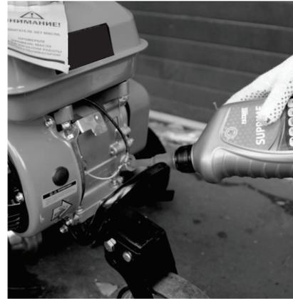
Закрутите болт сливного отверстия. Залейте новое масло до уровня, указанного на щупе. При эксплуатации культиватора при сильной нагрузке или при повышенной температуре окружающего воздуха масло следует заменять каждые 25 моточасов. Помните, что мотокультиватор поставляется без моторного масла в двигателе.
