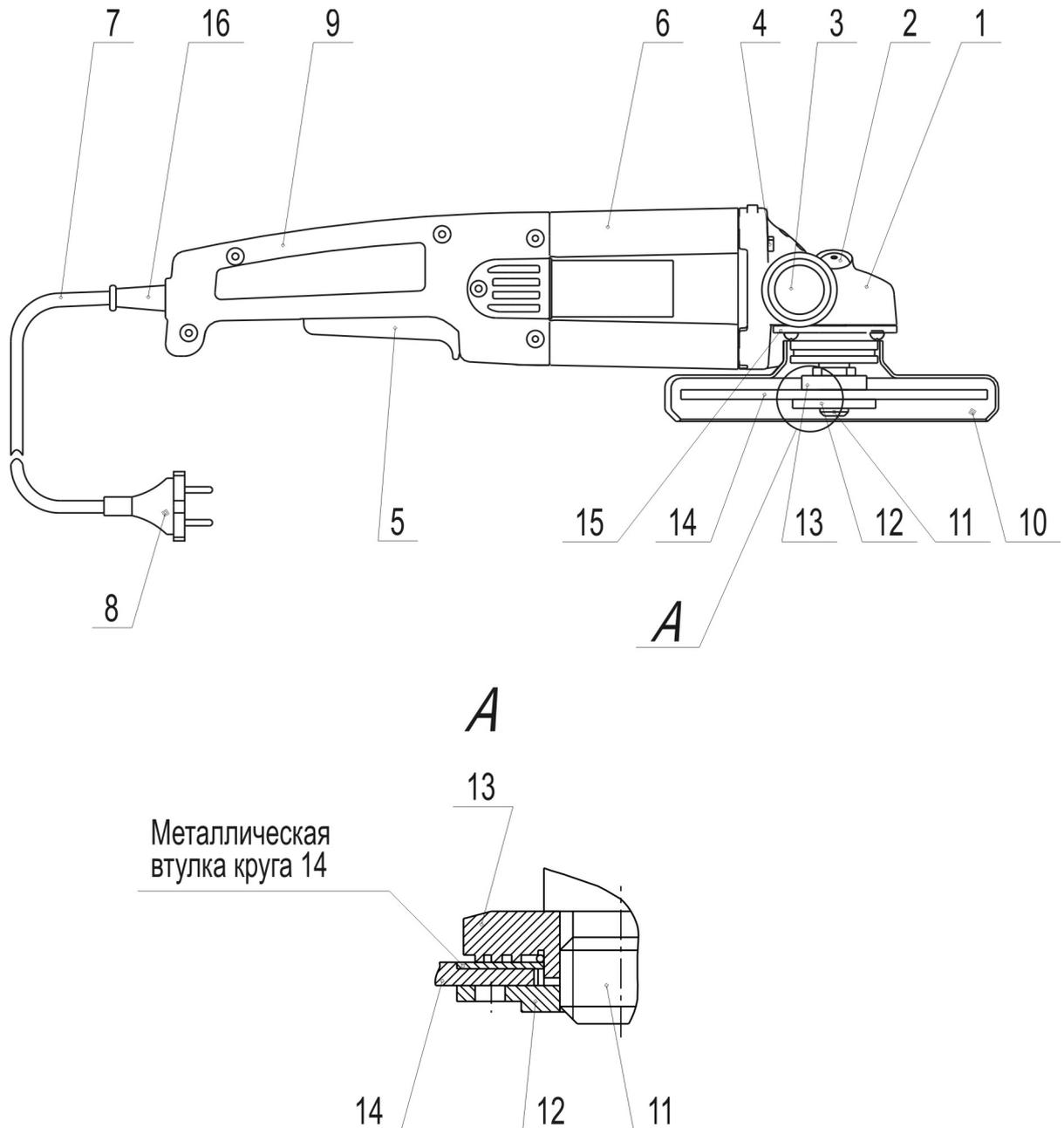
1 - редуктор; 2 - кнопка; 3 - ручка; 4 - винт; 5 - выключатель; 6 - электропривод; 7 - шнур питания; 8 - штепсельная вилка; 9 - ручка-накладка; 10 - кожух; 11 - шпиндель; 12 - гайка; 13 - диск; 14 - круг; 15 - нижний корпус редуктора; 16 - защитная трубка
