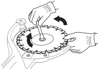
**ПРЕДУПРЕЖДЕНИЕ!** Диски должны вращаться при затянутой гайке. Это будет свидетельствовать о том, что ремень не зажат на дисках между объединенными половинками приводного ремня, когда диски и приводной ремень стягиваются с помощью гайки. Лучше это делать поочередно, то есть слегка затянуть, немного провернуть и так повторять, пока диски не будут закреплены.
