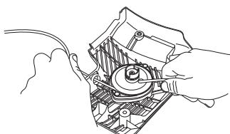
Замкните стартовый шнур вокруг центра шкива шнура, как это показано на рисунке. Сильно затяните крепление и проследите за тем, чтобы свободный конец был как можно короче. Закрепите конец стартового шнура в ручке стартового шнура.
