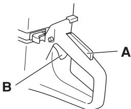
Замок триггера остается нажатым до тех пор, пока нажат дроссель. Когда вы отпускаете рукоятку, то ручка газа и фиксатор ручки газа возвращаются в свое первоначальное положение. Это осуществляется благодаря двум независимым друг от друга системам пружин. В таком положении ручка газа автоматически фиксируется на холостых оборотах.
