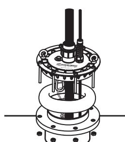
При первом пуске насоса в новой скважине необходимо учесть возможность попадания в насос большого количества песка. При подаче насосом сильно загрязненной воды категорически запрещается выключать насос во избежание его заклинивания вследствие оседания песка из напорной магистрали. Дайте ему поработать.
