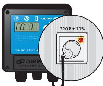
осуществляется посредством сигнала от датчика напряжения, если величина напряжения выйдет из диапазона 198 В - 242 В и это условие сохраняется в течение 2-3 секунд; При возникновении данного условия насос останавливается, система переводится в «тайм-аут» и на индикатор выводится мигающая надпись **FO-3**.
