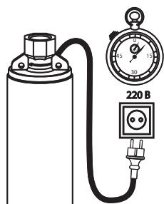
Перед погружением насоса необходимо проверить его работу, включив в электросеть на 3 - 5 секунд. Если Вы убедились, что насос заработал, его можно погрузить в скважину (или другой источник воды, соответствующий его производительности).
