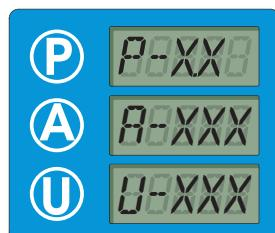
Основным режимом является индикация **P-X.X** давления в водопроводной сети, при нажатии кнопки **«U»** индикатор переходит в режим индикации **U-XXX** напряжения в электросети, при нажатии кнопки **«A»** индикатор переходит в режим индикации **A - XXX** потребляемого тока. Индикация напряжения и тока длится 20 секунд, затем индикатор переводится в режим индикации давления в водопроводной сети.
