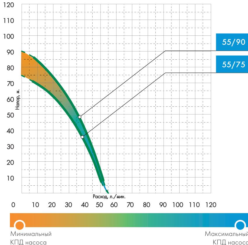
\* Заявленные характеристики насосов были получены при испытании с холодной чистой водой без газа и абразивных примесей, а также Ø напорной магистрали согласно модели насоса и напряжением 220В.
