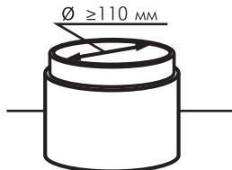
При использовании насоса в скважине необходимо установить его в обсадную трубу с минимальным внутренним диаметром 110 мм.
