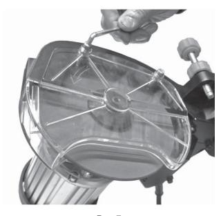
Рис.7 Установите и закрепите болтами защитный кожух заточного диска (Рис.7)
