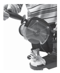
**Рис.8**Закрепите рабочую рукоятку в основание корпуса кожуха заточного диска (Рис.8).
