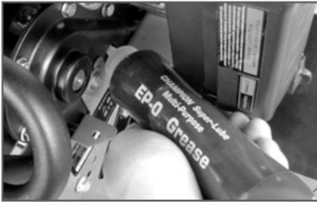
**Рис. 22** Добавление смазки в редуктор
